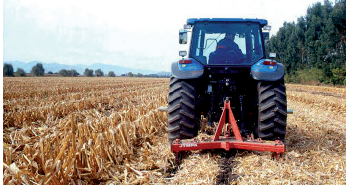
Subsolador pasando a través de un rastrojo de maíz finamente picado. Se observa la alta cantidad de rastrojo en pie que queda después de la trilla
