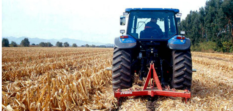
Subsolador pasando a través de un rastrojo de maíz finamente picado. Se observa la alta cantidad de rastrojo en pie que queda después de la trilla.
