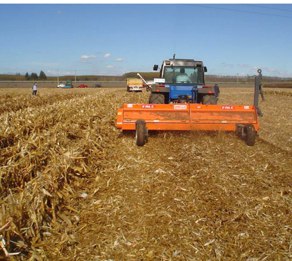
Equipo triturador de caña picando finamente un rastrojo de maíz.
